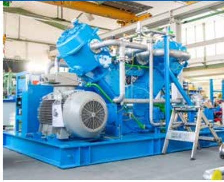
Seit über 135 Jahren steht Mehrer Compression für Technik, auf die man sich verlassen kann. Unsere ölfreien Kolben- und Membrankompressoren verdichten Gase wie Wasserstoff, Kohlendioxid, Erdgas, Biogas oder Stickstoff – überall dort, wo saubere und sichere Verdichtung entscheidend ist.
